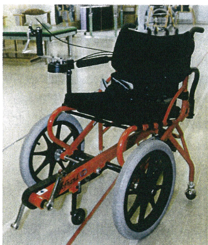
▲足こぎ車いす。ペダル(座面上)は簡単に脱着できる。
